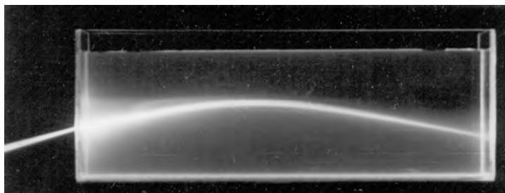
Рис. 1.7. Распространение света в оптически неоднородной среде: в кювете сверху находится вода, внизу — насыщенный раствор поваренной соли; падающий на кювету слева световой пучок был сделан видимым благодаря табачному дыму
