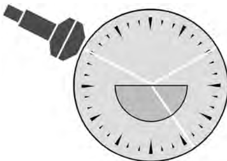
Рис. 9.5. Световой пучок, падающий из одной среды в другую, частично преломляется и частично отражается
