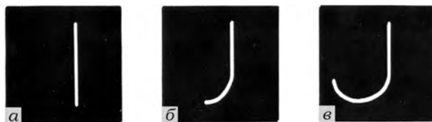
Рис. 2.15. Так при неравномерном нагреве призмы деформируется светлая полоска, образованная на экране узким пучком, прошедшим через призму
