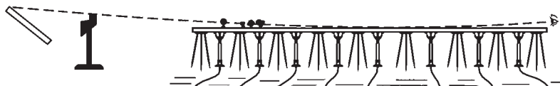
Рис. 7.1. Предложенная Р. Вудом модель миража, в которой для нагревания использованы газовые горелки
