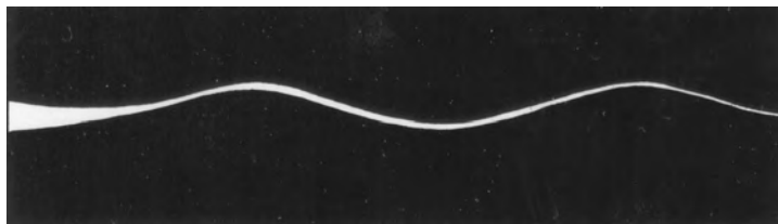
Рис. 1.10. Волнообразный ход светового пучка: рисунок сделан по фотографии Р. Вуда
