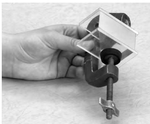
Рис. 2.12. Способ предотвращения завалов по краям преломляющих поверхностей призмы
