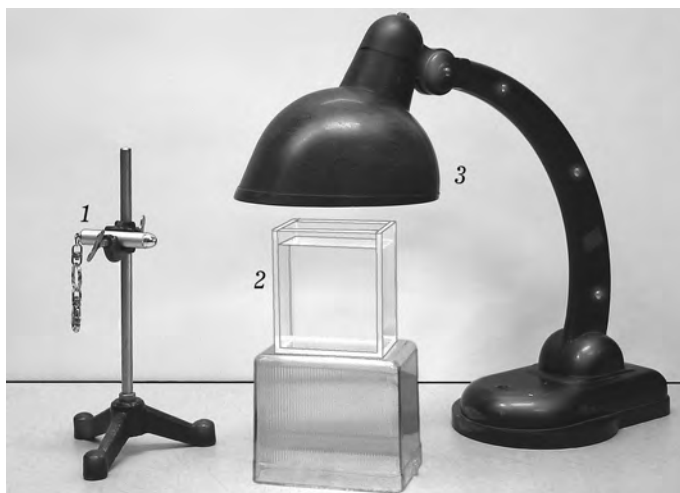
Рис. 2.3. Возможный вариант экспериментальной установки для исследования распространения света в неравномерно нагретой жидкости: 1 — полупроводниковый лазер, 2 — кювета с водой, 3 — лампа накаливания
