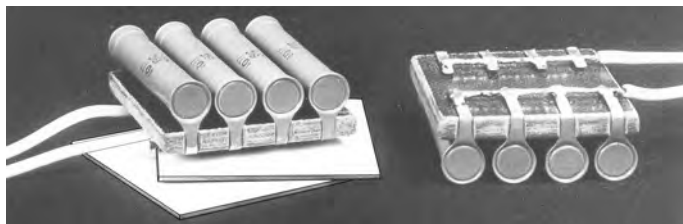
Рис. 4.9. Нагреватели из радиотехнических резисторов: под левым нагревателем расположены изолирующие гетинаксовые пластинки
