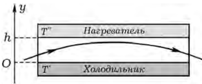
Рис. 6.1. Между нагревателем и холодильником расположен плоскопараллельный брусок из оргстекла
