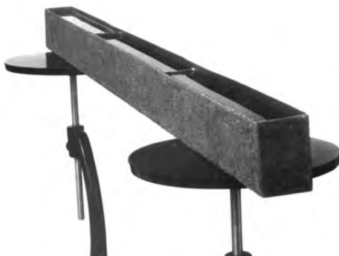
Рис. 7.6. Внешний вид кюветы для наблюдения миража в воздухе
