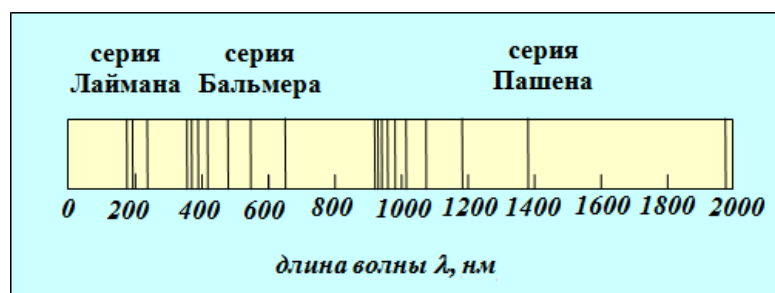
Рис. 91. Длины волн, излучаемые атомом водорода: спектр состоит из серий
