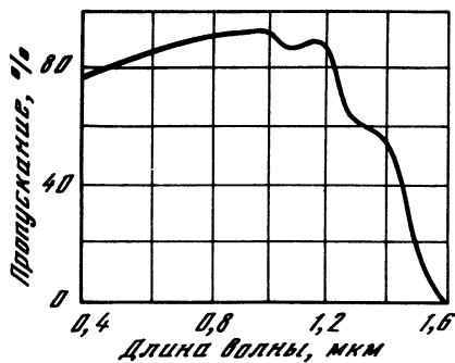
Рис. 4 Спектральное пропускание АДР толщиной 8 мм
