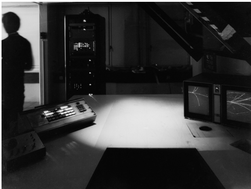
Пульт оператора системы ERASME, построенной на основе подхода: человек в помощь компьютеру
