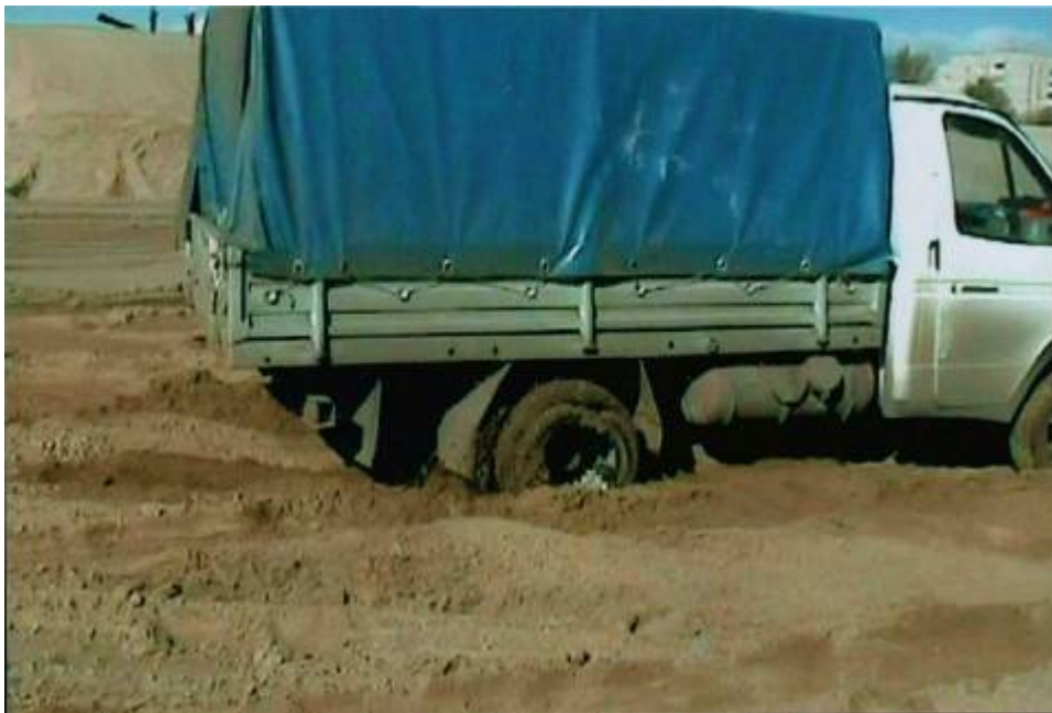
Рисунок 85 – Автомобиль ГАЗ-3302 с универсальными колесными движителями при транспортировке груза по песчаной целине
