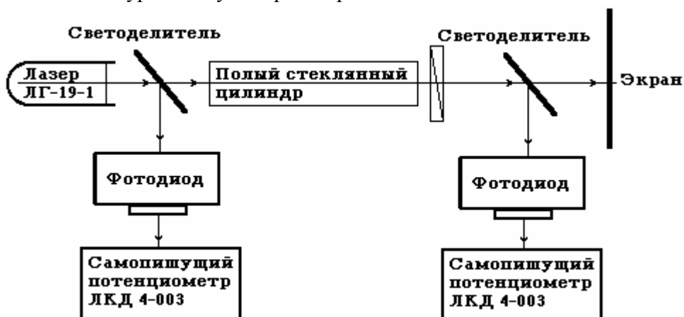
Рис. 6-3-4. Схема установки на базе He-Ne лазера ЛГ-19-1 для изучения эффектов светорассеяния в спиртовом растворе красителя PPG.
