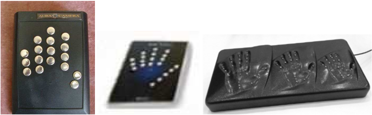
Рис. 4-1-9. Аурасенсоры выпуска 2006 и 2013 года. 17 и 20 электродов. Тройной сенсор предназначен для снятия данных с разных типов рук и более точнее снимает показания, так как имеет три различных варианта исполнения, которые учитывают особенности размера руки.
