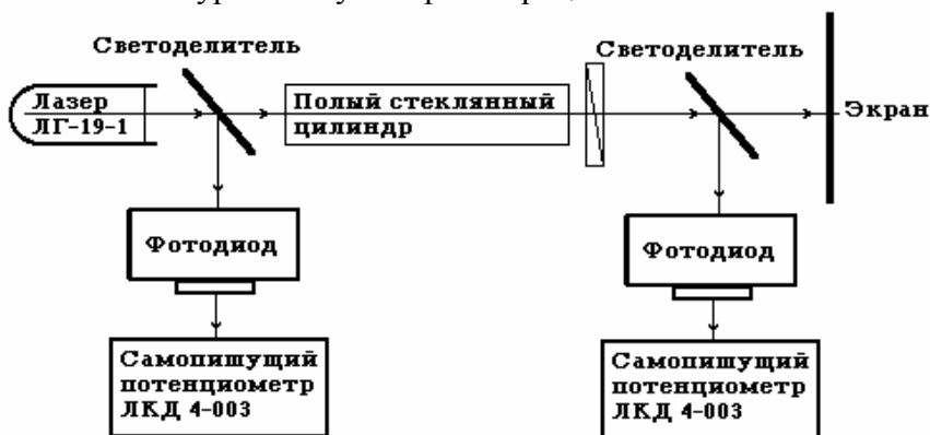
Рис. 2-2-5. Схема установки на базе He-Ne лазера ЛГ-19-1 для изучения эффектов светорассеяния в спиртовом растворе красителя PPG.
