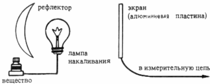
Рис. 6-2-7. Схема формирования сигнала для передачи воздействия на расстояние.
