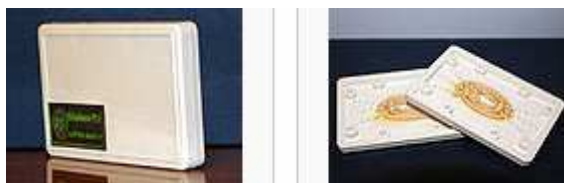
Рис. 2-6-4. Генератор «Гамма-7Р» и его устройство.
