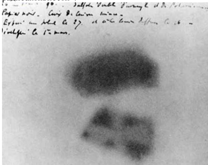
Рис. 1-5-5. Фотопластинка Беккереля. Ясно видна тень медного креста, помещенного между пластинкой и солью урана. Контактная фотография.
