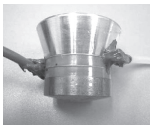
Рис. 67. Внешний вид пьезоэлектрического генератора УЗ и его схематический разрез: 1 – блок пьезоэлектрических преобразователей, 2 – металлическое соединение с дном контейнера с водой
