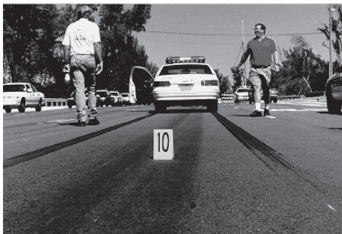
Рис.14. Длина черного следа, оставленного колесами машины после торможения, помогает оценить скорость автомобиля
