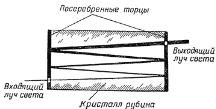
Рис. 33. Чем больший путь проходит в возбужденном кристалле луч света, тем больше становится его яркость
