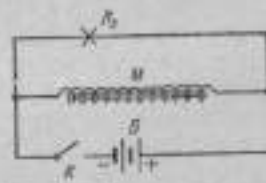
Рис. 47. Схема установки для демонстрации возбуждения э. д. с. самоиндукции при размыкании цепи.
