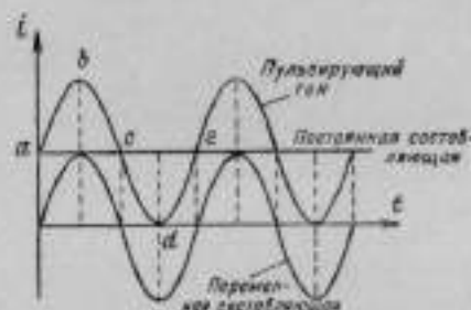
Рис. 84. Сложение постоянного и синусоидального переменного токов.
