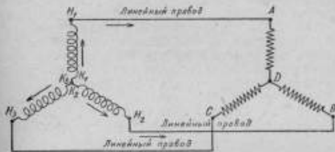
Рис. 64. Схема соединения обмоток генератора и приемников энергии звездой при трехпроводной системе.
