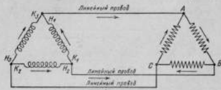
Рис. 67. Схема соединения обмоток генератора и приемника энергии треугольником.
