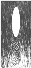
Рис. 3. Вихревая дорожка Кармана позади эллиптического цилиндра. (Из книги Prandtl, Handbuch der Experimentalphysik , Vol. 4, part 1, p. 6, Leipzig, 1931.)
