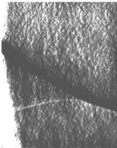
Рис. 9. Взаимодействие ударной волны с пограничным слоем. (Из работы H.W.Liepmann, Interaction Between Boundary Layer and Shock Wave in Transonic Flow, J.Aero.Sci. , Vol. 13, pp. 632-37, 1946, с разрешения I.A.S.)
