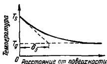
Рис. 3-2. Профиль температуры по нормали к поверхности тела, погруженного в поток холодной жидкости.
