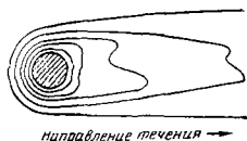
Рис. 3-1. Изотермы вокруг тела, погруженного в поток жидкости.
