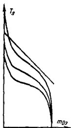
Рис. 5-32. Влияние ограниченного количества избыточного воздуха.
