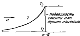
Рис. 3-4. Распределение температуры при одномерном течении через пористую стенку.
