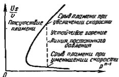
Рис. 5-27а. Область устойчивого горения в гомогенной зоне реакции при наличии радиационных тепловых потерь.
