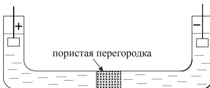
Рис. 4.38. Схема установки для изучения электромиграции ионов актиноидов
