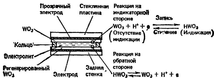
Рис. 25. Элемент электрохромной матрицы на основе вещества \text{WO}_3
