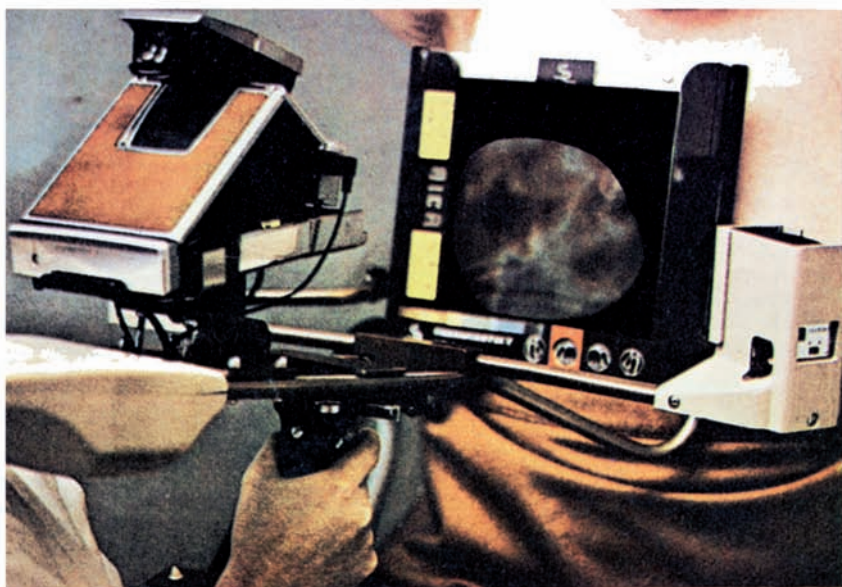
Рис. 362. Тепловизор «Кристотермограф» с гранулированным жидкокристаллическим преобразователем ИК-изображения
