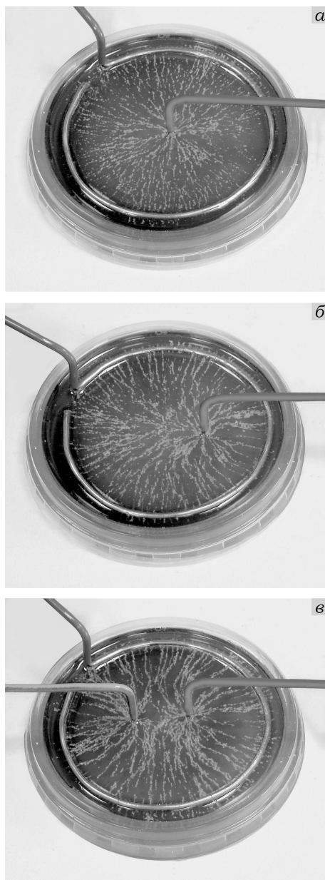
Рис. 8.13. Моделирование электростатических полей: а — поле одиночного точечного заряда; б — модель поля линейного заряда внутри экранирующего цилиндра; в — поле двух одноименных зарядов
