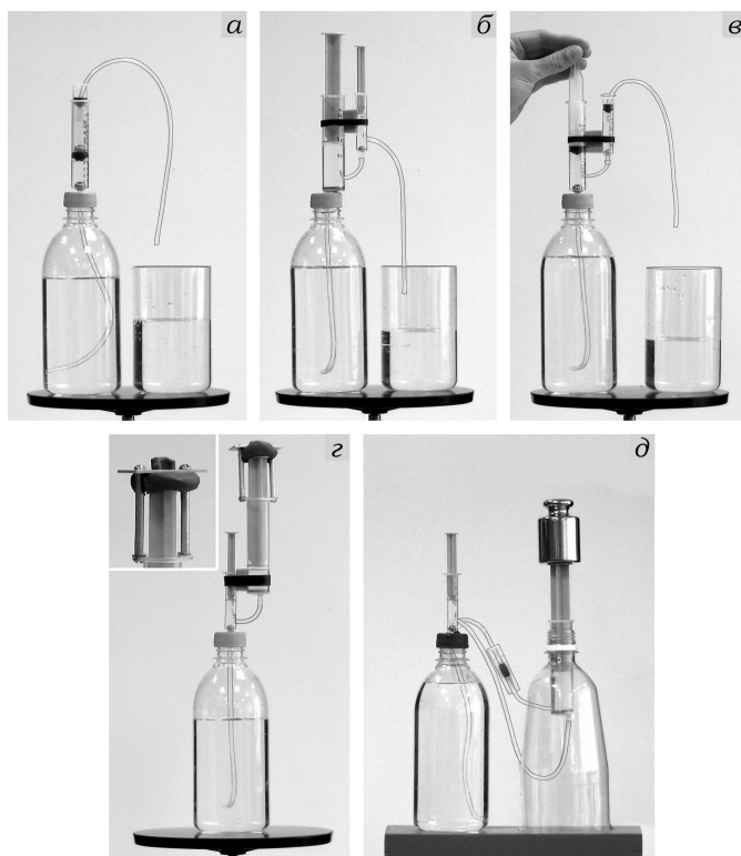
Рис. 5.13. Подготовленные к демонстрации модели гидравлических механизмов: а — гидравлический насос с клапаном внутри поршня; б , в — насосы с воздушными камерами; г — гидравлический пресс; д — гидравлический домкрат
