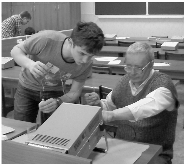
Рис. 8.8. Исследование пьезоэлектрического датчика давления с помощью электронного осциллографа
