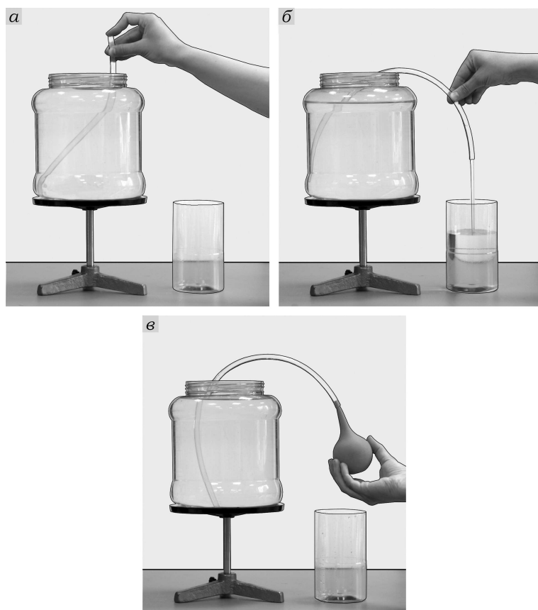
Рис. 5.15. Демонстрация сифона: а — заполнение трубки погружением в воду; б — работа сифона; в — заполнение трубки резиновой грушей
