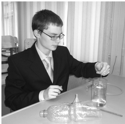
Рис. 6.6. Школьник исследует образование кумулятивных струй жидкости различными воронками. Выполнение проектного исследования организовала студентка Глазовского пединститута М. Л. Ушакова
