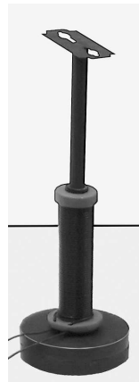
Рис. 7.19. Использование лезвия для настройки генератора в резонанс с вибратором
