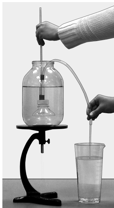
Рис. 6.9. Гидродинамический удар в автоматическом сифоне
