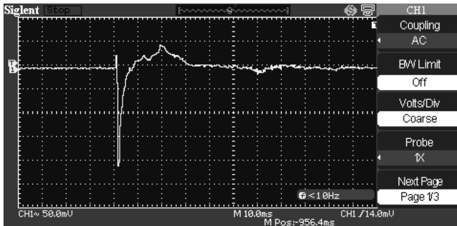
Рис. 46. Импульс после падения стержня на дно внутренней ёмкости
