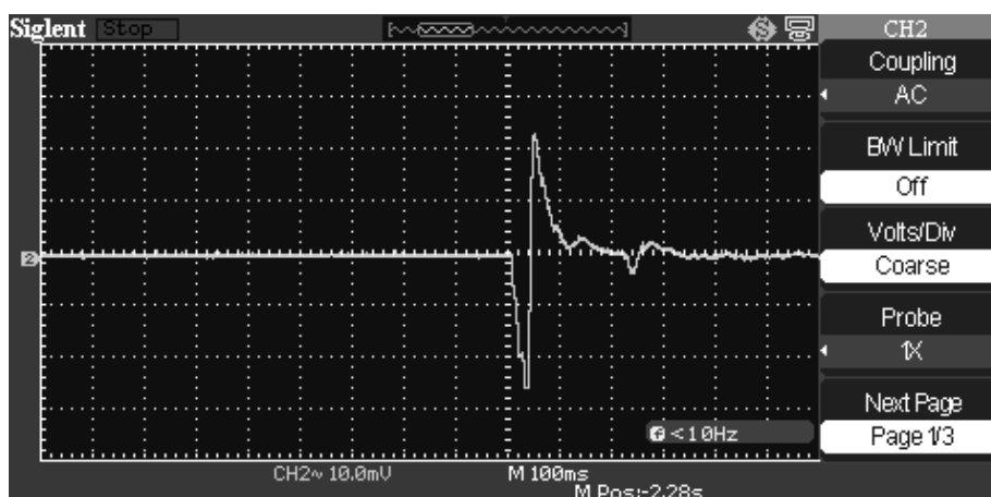
Рис. 51. Импульс, полученный при разрыве медной проволоки
