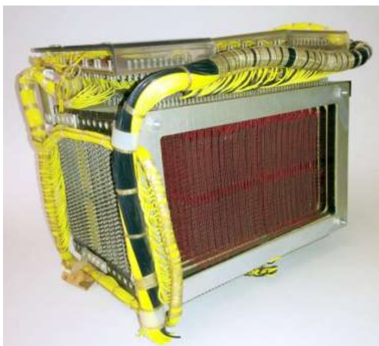
Рис. 73. Матрица ферритовой памяти суперкомпьютера CDC 6600(1964). Размер 10,8 \times 10,8 см, ёмкость 4096 бит
