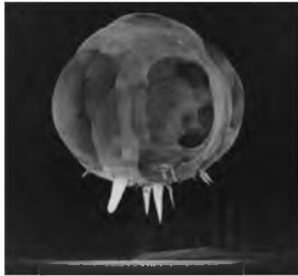
Рис. 36. Вид облака взрыва через 1 мс после детонации ядерного заряда, время экспозиции 1 мкс.
