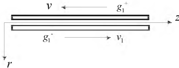
Рис. 16. Движущийся проводник с током.
