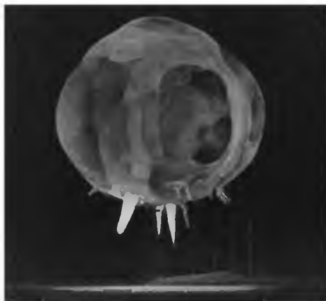
Рис. 5.20. Вид облака взрыва через 1 мс после детонации ядерного заряда, время экспозиции 1 мкс.
