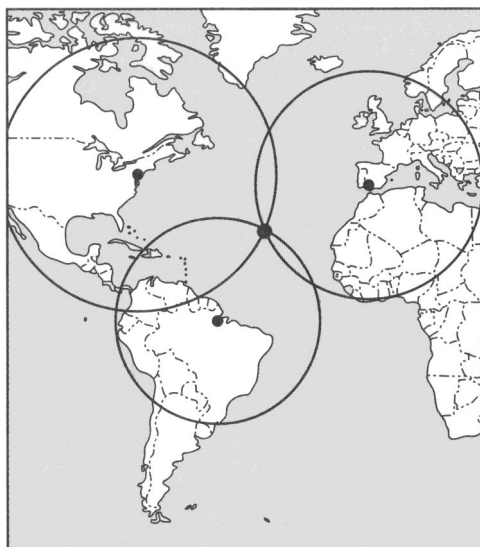
Рис. 11.4. Метод локализации места землетрясения. Тремя точками отмечено положение сейсмических станций в США, Бразилии и Испании, а место пересечения окружностей с радиусами, равными расстояниям до эпицентра, определяет его координаты на карте где-то в середине Атлантического океана
