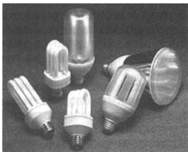
Рис. 18.5. Внешний вид нескольких компактных люминесцентных ламп, содержащих электронный пускорегулятор и оканчивающихся таким же винтовым контактом E27, как и у обычных ламп накаливания
