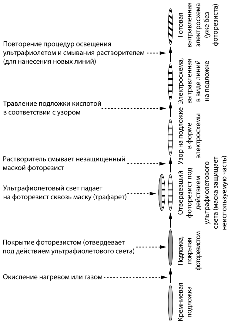
Рис. 9.2. Создание микрочипа с помощью литографии
