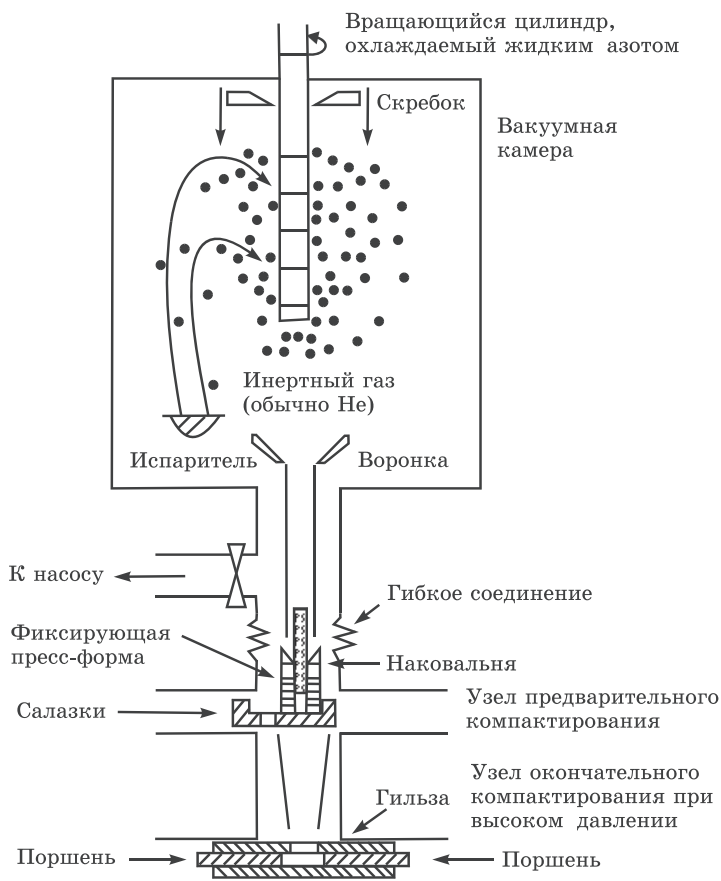
Рис. 3.19. Схема аппаратуры для получения компактных нанокристаллических материалов методом испарения, конденсации и компактирования
