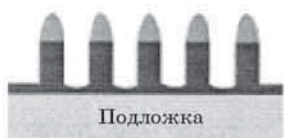
Рис. 7.36. Этапы травления остаточного и планаризационного слоев
