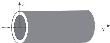
Рис. 6.3. Трубчатый пьезоэлемент
