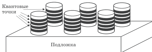
Рис. 4.21. Массив квантовых точек, полученный с помощью литографии из квантовых ям (см. рис. 4.20)
