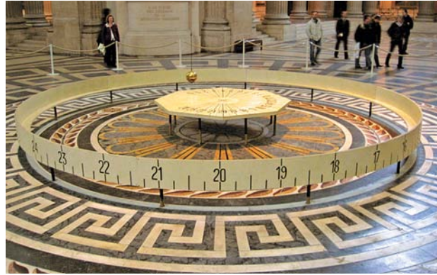
Маятник Фуко в парижском Пантеоне наглядно доказывает, что Земля вращается вокруг своей оси
