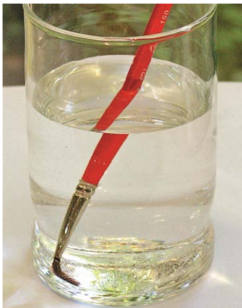
Из-за преломления объект, частично погруженный в воду, кажется сломанным или изогнутым на границе между средами
