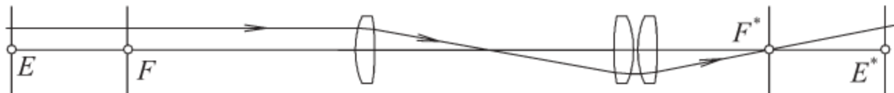
Рис. К.12. Положение главных и фокальных точек в объективе из двух менискообразных линз
