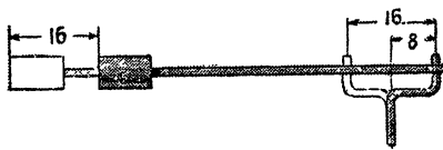
Рис. 86. Схема величины хода поршня.
