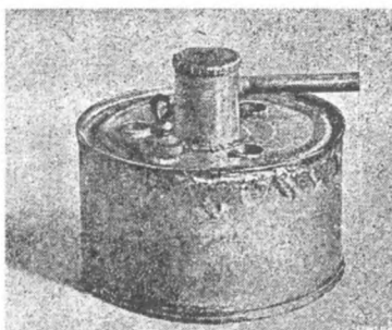
Рис. 78. Фото. Простой котел из консервной банки.
