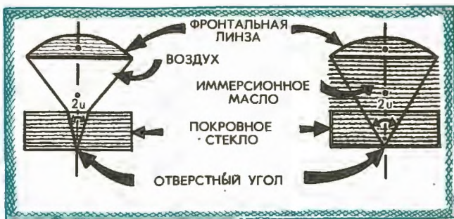
Рис. 82. Ход лучей в сухой и иммерсионной системах микроскопа.
