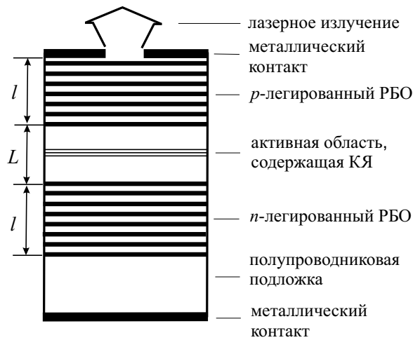
Рис. 14.1: Геометрия поверхностно-излучающего инжекционного микролазера с активной областью, содержащей три квантовых ямы.
