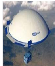
Такой проект дискообразного дирижабля "Локомоскойнер" разрабатывался в конце 80-х. Дальность полета таких "Локомоскойнеров" составляет от 250 до трех тысяч км. Грузоподъемность до 600 тонн, а диаметр корпуса - от 50 до 246 метров.
