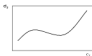
Рис. 6.10. Типичный вид зависимости разрушающего напряжения при растяжении сшитых полимеров от концентрации узлов полимерной сетки
