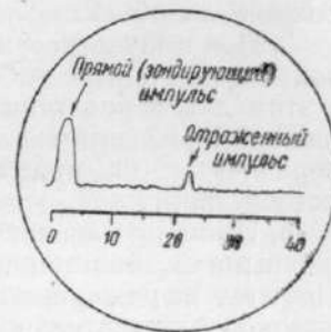
Рис. 98. Экран электроннолучевой трубки индикатора радиолокационной станции.
