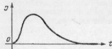
Рис. 25. График аperiodического разряда.
