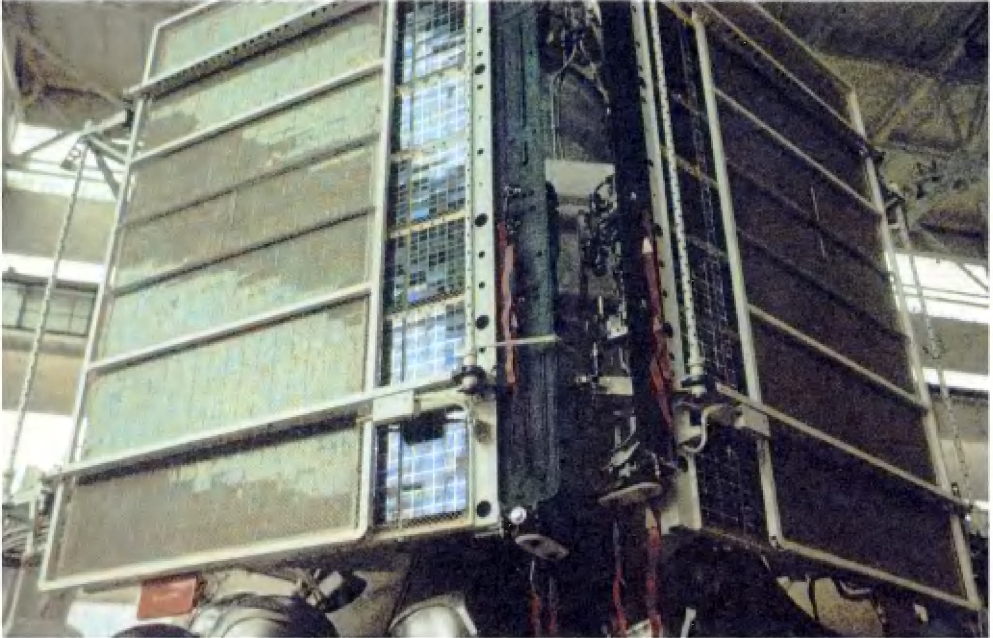
Солнечные батареи автоматических межпланетных станций «Венера-15» и «Венера-16» в испытательном корпусе.
