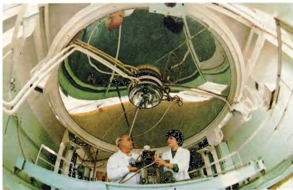
Высокотемпературная солнечная печь с диаметром зеркала в три метра.
