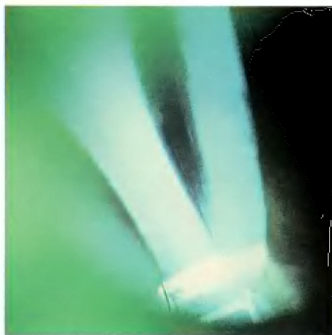
Магнитное поле «Огры-4» — возбужденные атомы газового разряда расходятся вдоль магнитных силовых линий.
