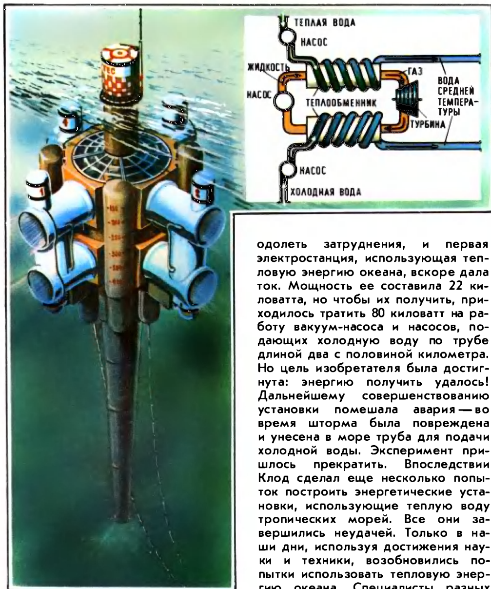
Схема и внешний вид электростанции «ОТЕК»
