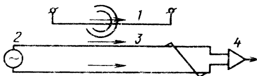
Рис. 5. Взаимодействие электромагнитной наводки с бифилярным проводом: 1 – источник наводки; 2 – источник сигнала; 3 – линия связи; 4 – дифференциальный приемник
