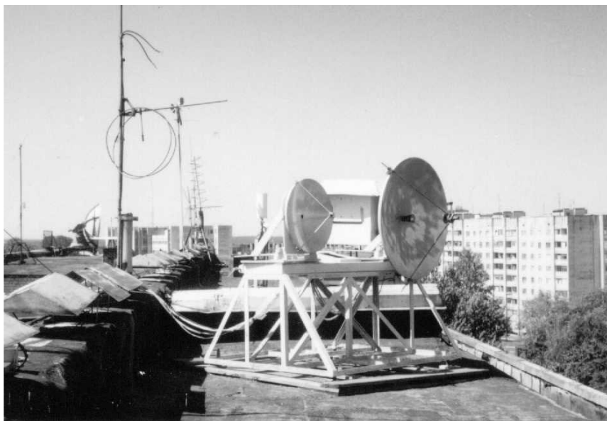
Рис. 21.2 Радиотехнический приемно-передающий измерительный пункт "А" в г. Харьков [24, 26]. В эксперименте применялась только антенна большего диаметра
