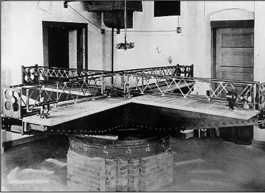
Рис. 18.10. Интерферометр Морли и Миллера, предназначенный для проверки гипотезы Лоренца–Фицджеральда, 1904 г.
