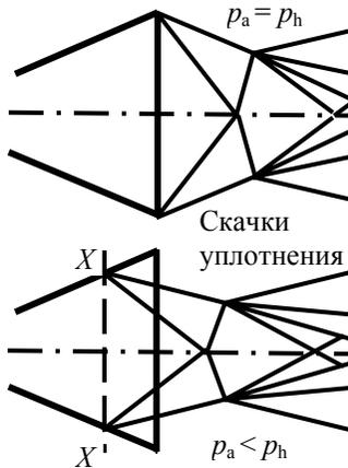
Рис. 2.6 Вход скачков уплотнения в реактивное сопло
