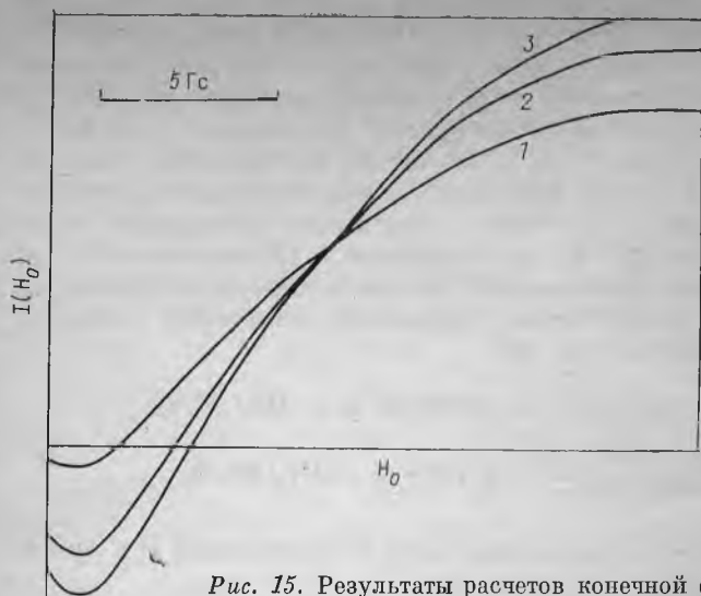
Рис. 15. Результаты расчетов конечной формы провала в компоненте m=1 спектра ЭПР нитроксильного радикала (уширением линий за счет окружающих ядер пренебрегается) для модели переходов между двумя неэквивалентными положениями [11].
