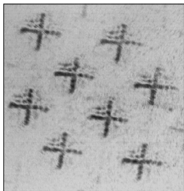
Рис. 5.123. Распределение интенсивности (негатив) в виде набора из восьми крестов, сформированное бинарным фокусатором
