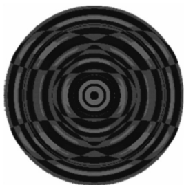
Рис. 5.172. Кодированная фазовая функция пропускания элемента, формирующего две световые «бутылки»
