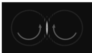
Рис. 5.132. Направления увеличения фазы вдоль колец для ДОЭ, формирующего два вихревых пучка 60-го порядка
