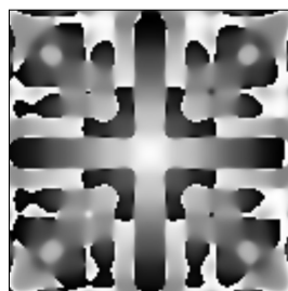
Рис. 5.90. Формируемое в плоскости фокусировки распределение светового поля: интенсивность (негатив) ( a ) и фаза ( б )
