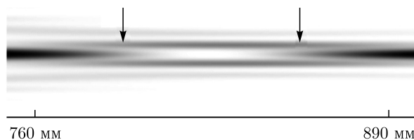
Рис. 5.151. Распределения интенсивности (негатив) для сформированной световой «бутылки» вдоль оптической оси. Стрелочками указана область формирования световой «бутылки»
