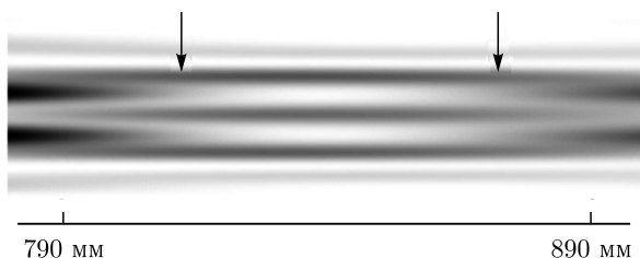
Рис. 5.173. Распределения интенсивности (негатив) для двух сформированных световых «бутылок» вдоль оптической оси. Стрелочками указана область формирования световых «бутылок»
