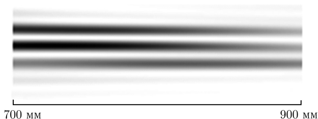
Рис. 5.193. Распределения интенсивности (негатив) для двух сформированных полых световых пучков
