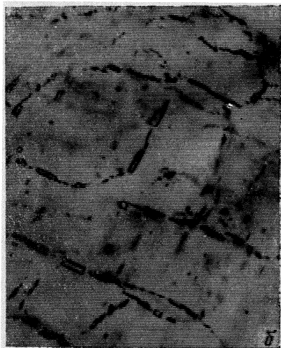
Рис. 28. Расположение ограненных пор на дефектах структуры:
