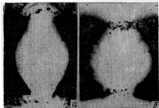
Рис. 34. Возникновение пористости в диффузионной зоне, \times 70 [188]: а — Cu — Pt; б — Co — Ni
