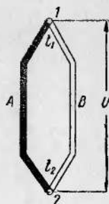
Рис. 1. Принципиальная схема термопары.
