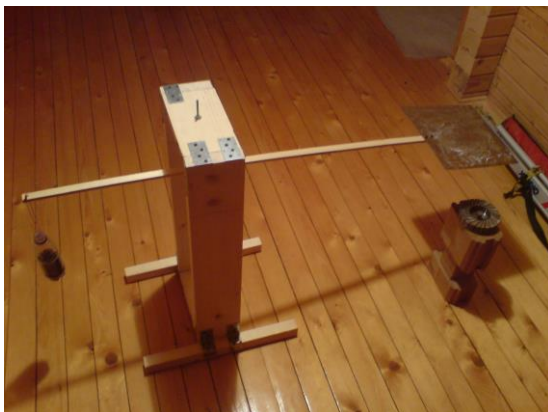
Рис. 2.6. Крутильные весы для проверки влияния геопатогенного излучения на металлические плоскости: общий вид
