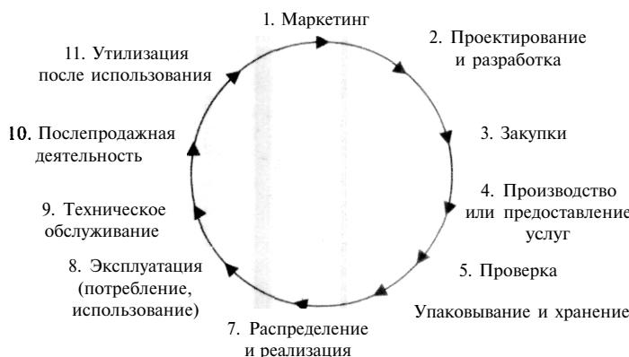
*Рис. 2. Процессы жизненного цикла продукции*
