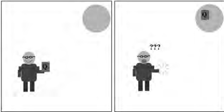
Рис. 8.5. Локальное сохранение заряда. Ситуация, изображенная на этом рисунке, в реальности невозможна: заряд не может исчезнуть в одном месте и мгновенно появиться в другом, удаленном от первого на большое расстояние
