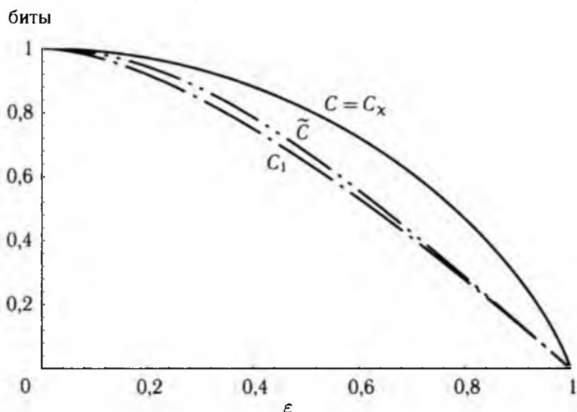
Рис. 5.1. Пропускная способность канала с двумя чистыми состояниями
