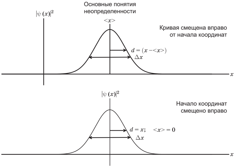
Рис. 8.2. Основные понятия неопределенности. Вверху: \langle x \rangle находится справа от начала координат. Отклонение d может быть положительным или отрицательным. Общая неопределенность \Delta x (> 0) характеризуется средним значением d^2 . Внизу: начало координат сдвинуто вправо, \langle x \rangle = 0 , \Delta x имеет то же значение
