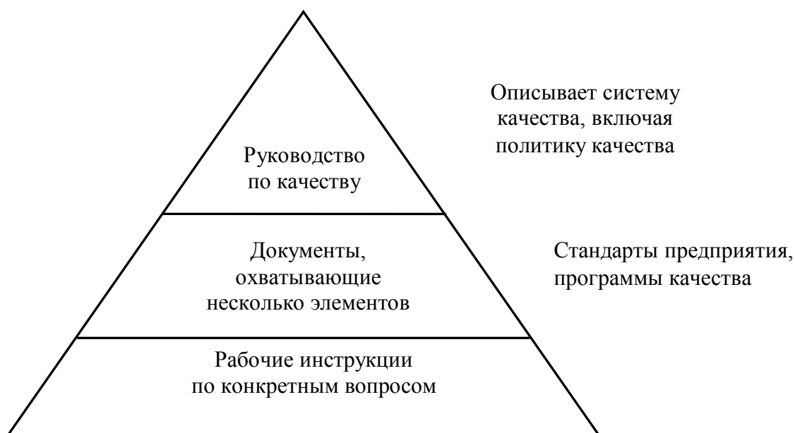
Рис.8.1. Иерархия документации система качества
