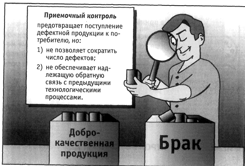
Рис. 3-2. Приемочный контроль выявляет дефекты.
