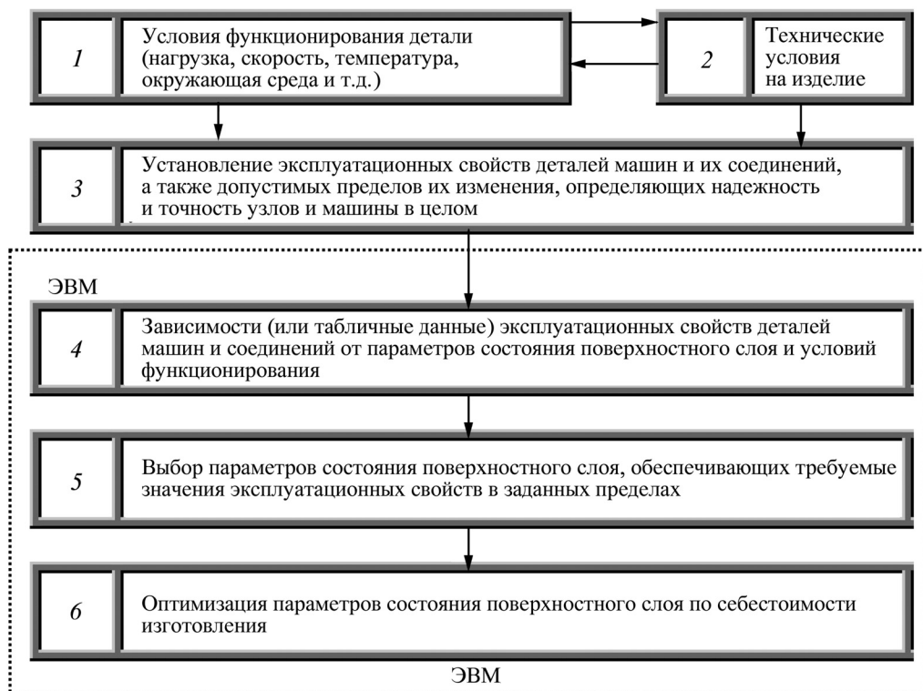
Рис. 2.45. Структурная схема выбора конструктором параметров состояния рабочих поверхностей деталей
