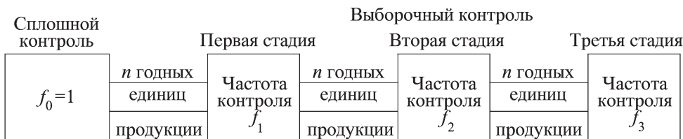
Рис. 3.14. Схема переходов на различные виды контроля для трехстадийного непрерывного контроля
