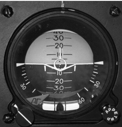
Рис. 7. Внешний вид одной из конструкций современного авиагоризонта
