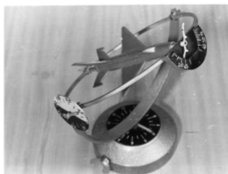
Рис. 3. Модель самолета, с помощью которой осуществляется перевод информации, закодированной в показаниях приборов в наглядное представление о пространственном положении самолета
