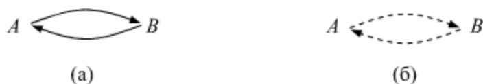
Рис. 7. Примеры положительной обратной связи двух систем A и B (знаковая петля совпадает с динамической)
